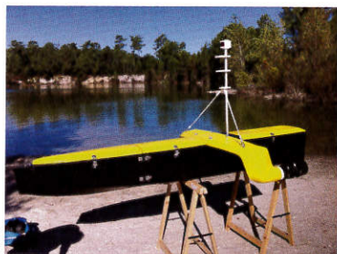
DRONE : Drone maritime mission bathymétrie, analyses physico chimique et des sédiments.
