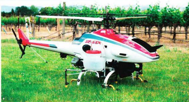
Exemple de drone utilisé au Japon pour l'épandage de produits phytosanitaires. Dans ce pays, les drones sont couramment utilisés, depuis plus de 20 ans.
